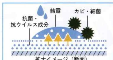
結露が起こると抗菌・抗ウイルス成分が溶け出しカビ・細菌を抑制します。
